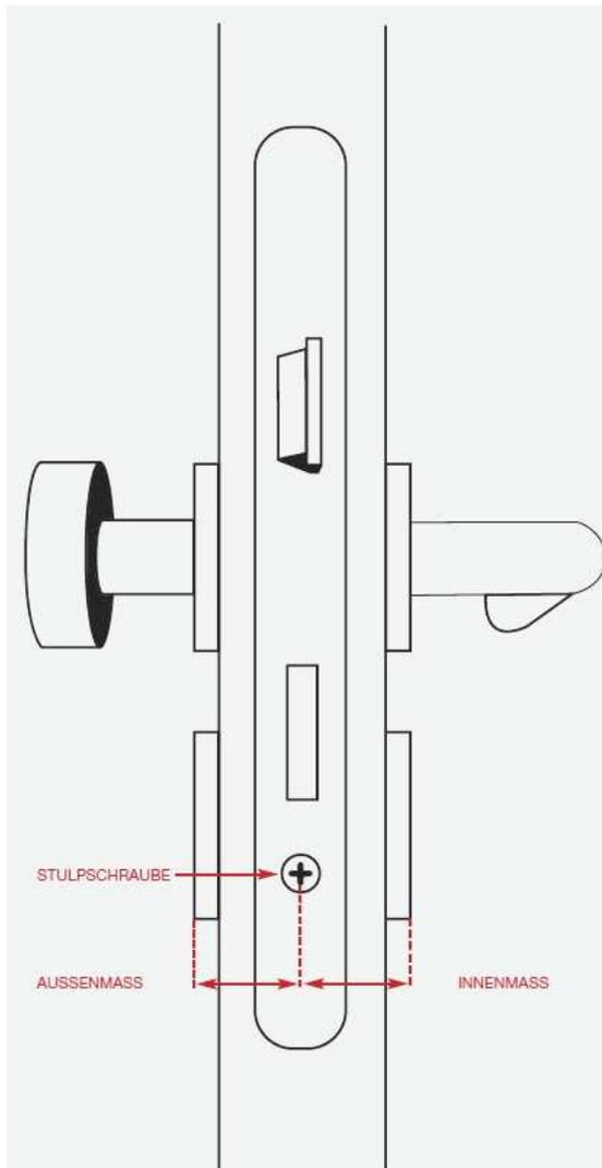
Sie messen den Zylinder von der Mitte der Stulpschraube nach außen A und nach innen B.
